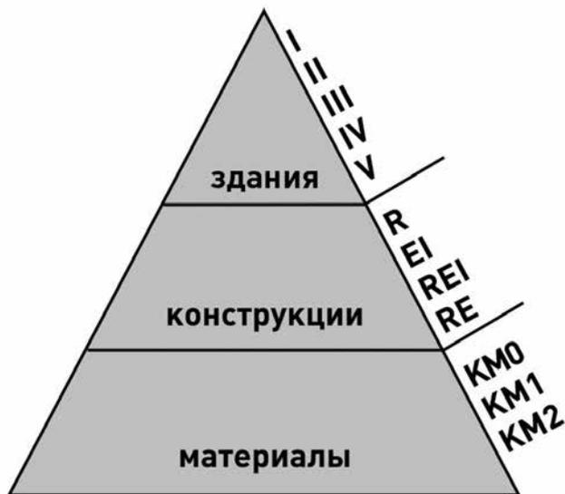
Рис. 1.5. Классификация зданий, конструкций и материалов по пожарной опасности
