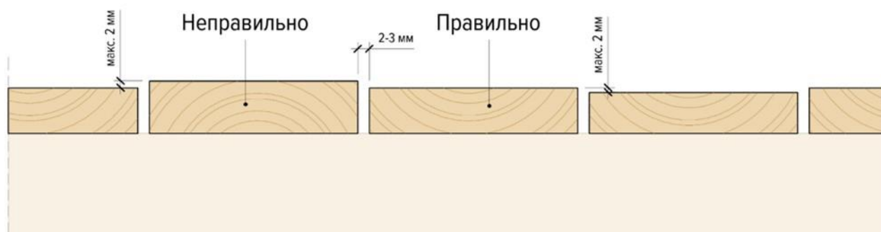
Рисунок 6.38 – Ориентация годовых колец в настиле из досок
