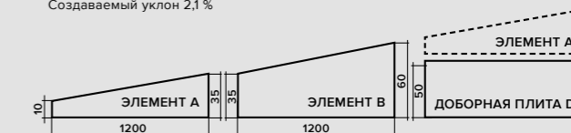
Плиты А и В. Создаваемый уклон 2,1 %
