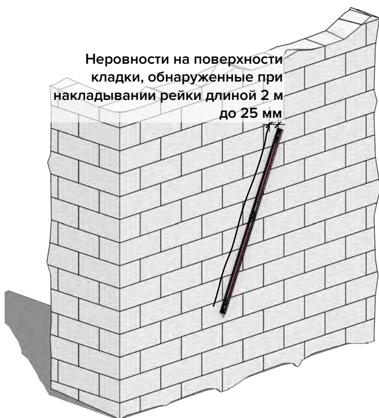
Рисунок 46. Определение неровностей основания под штукатурный фасад
