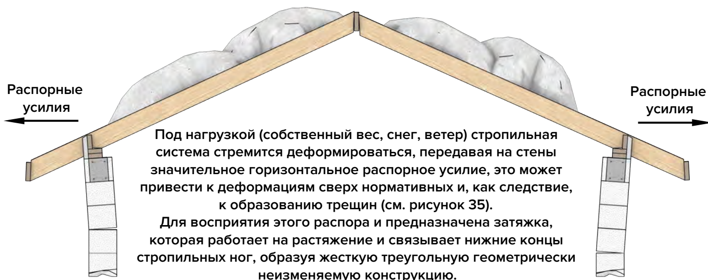
Рисунок 35. Влияние вертикальной нагрузки на висячую стропильную систему без затяжки
