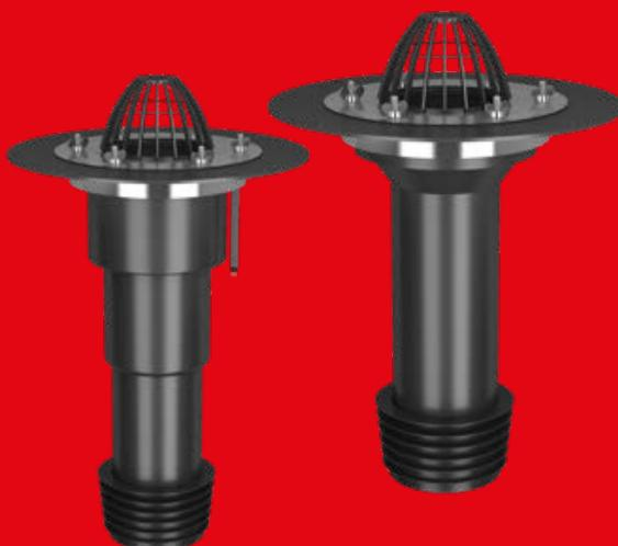
Применяются при проведении капитального ремонта на кровле. Быстро монтируются в существующую магистраль водоотведения из чугунных, стальных или пластиковых труб. Компактуются листвоуловителем и эластичной уплотнительной манжетой, выпускаются с обогревом и без обогрева.
