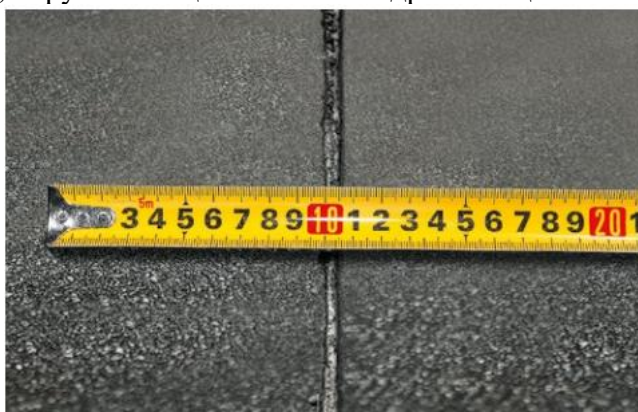
Рис.4.10 Вытек битумного вяжущего из-под кромки материала
