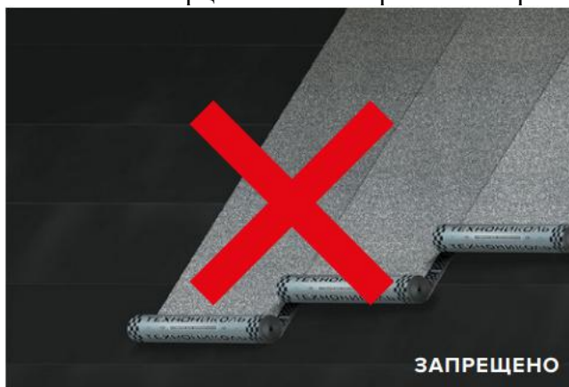
Рис. 4.13 Укладка рулонов второго слоя перпендикулярно рулонам первого слоя
