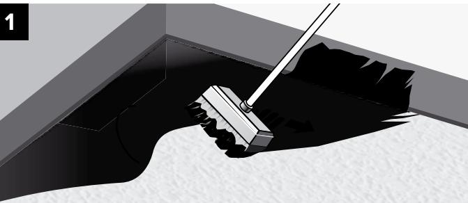
Поверхность должна быть ровной, сухой и чистой, без масляных пятен. Для улучшения адгезии рекомендуется обработать поверхность битумным праймером на водной основе или латексной грунтовкой в соответствии с инструкцией по применению.
