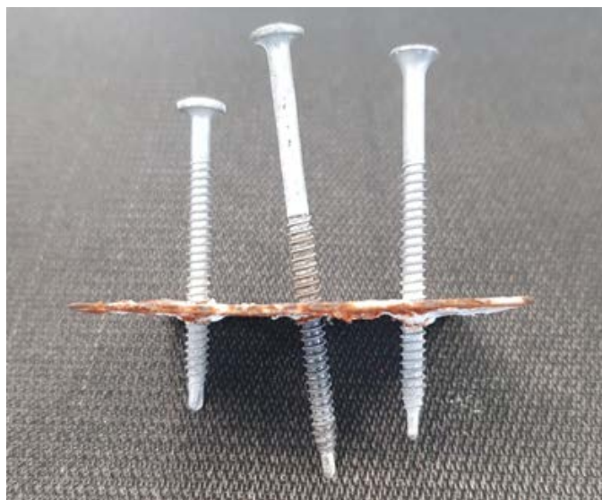
Саморезы TERMOCLIP после нахождения в испытательной камере в течение 1000 часов
