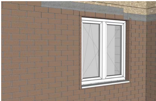
Рис. 196. Завершаем монтаж фасадной плитки (рис. 20а, 20б).
