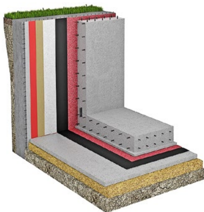
Рис. 2.11. Система ТН-ФУНДАМЕНТ СВГ
