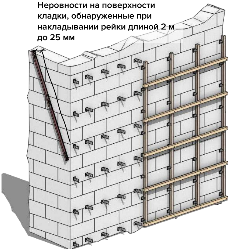
Рисунок 51. Системы навесного вентилируемого фасада
