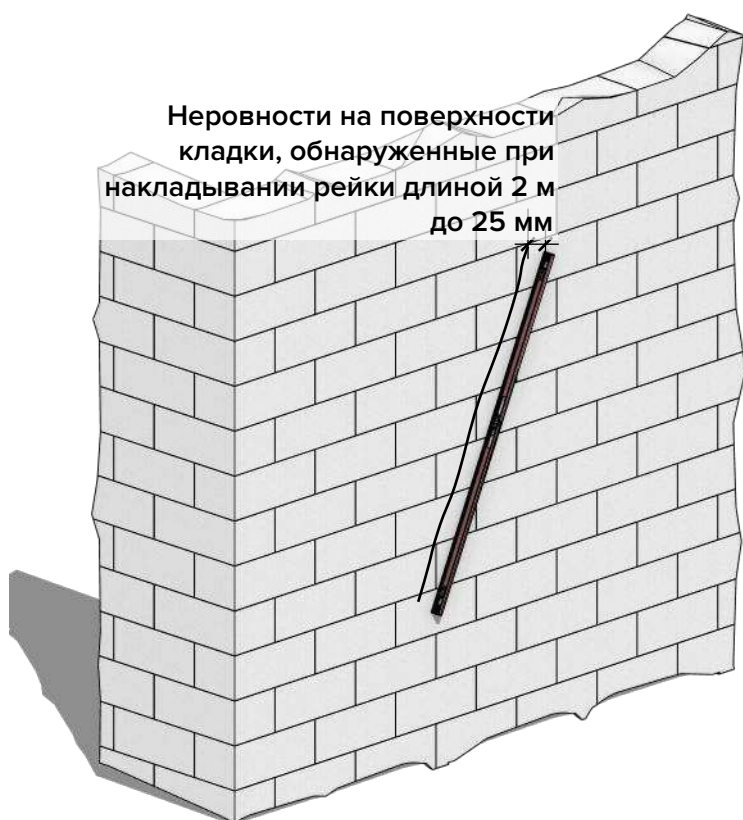
Рисунок 46. Определение неровностей основания под штукатурный фасад
