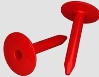
Телескопический крепеж TERMOCLIP 1 обеспечивает надежную фиксацию тепло- и гидроизоляционных материалов к несущим основаниям кровли из металлического профилированного листа, бетона и дерева. Применяется совместно с остроконечными и сверлоконечными саморезами диаметром 4,8 мм.
