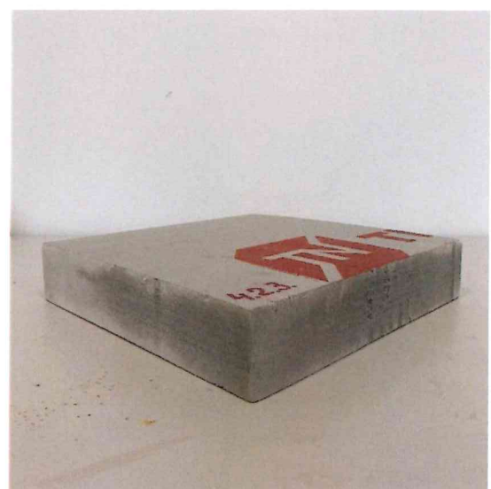
Рис. 11 Опытные образцы ТЕХНОНИКОЛЬ ТЕХНОПЛЕКС после испытаний
