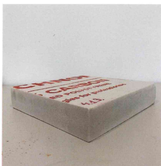
Рис. 10 Опытные образцы ТЕХНОНИКОЛЬ CARBON ECO после испытаний
